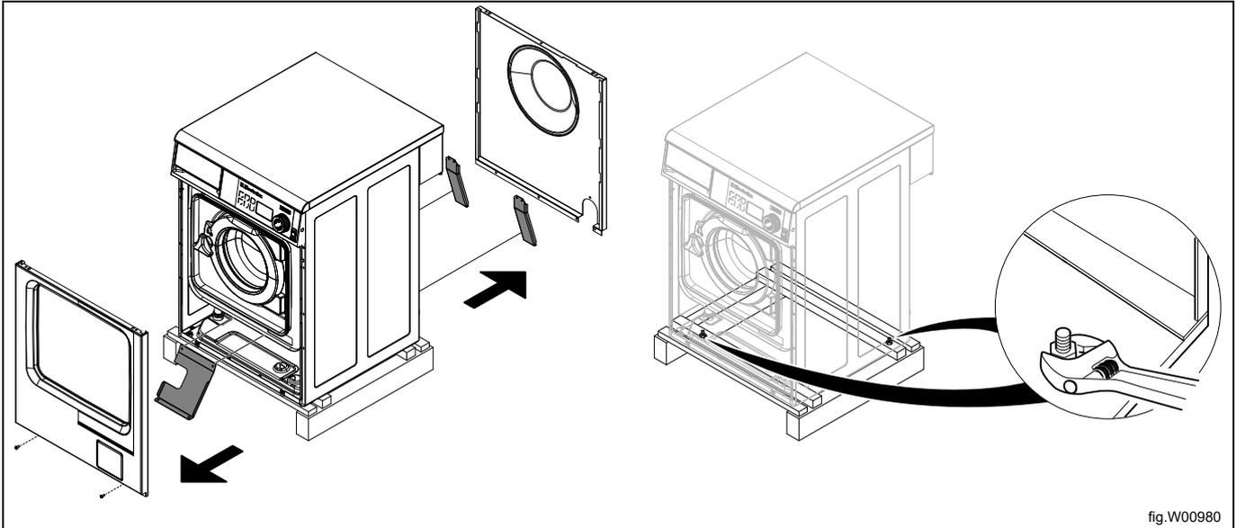
Ahora puede separar la máquina del palé. Levante la máquina por el bastidor inferior.
