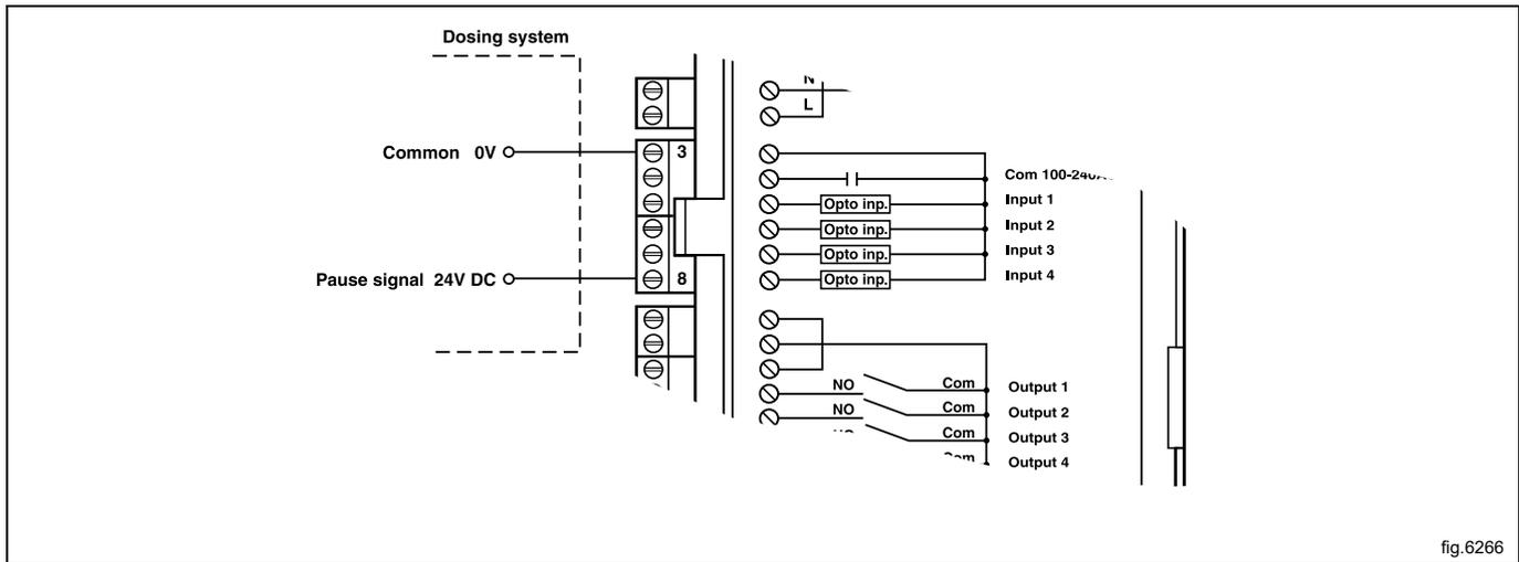
Conexión 7. Si se ha acoplado, aparecerá en la pantalla un mensaje de error cuando se vacíe alguno de los depósitos químicos. Sin embargo, el programa continuará.
